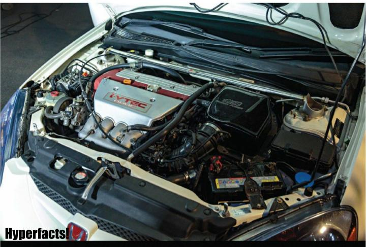
Engine: K20A iVTEC DOHC 16V inline-4
